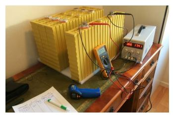
I nästa steg parallellkopplade vi cellerna. Innan vi parallellkopplade hade cellerna en spänning på mellan 3,353 och 3,362 V. Parallellkopplade blev spänningen 3,358 V. VI laddade först med max ström (20 A). Efter ungefär en och en halv timme var vi uppe i önskad spänning på 3,800 V. Vi laddade där till laddströmmen sjunkit till 10 A. Sedan fick vi stänga av laddningen och vänta till spänningen på cellerna sjönk till 3,650 V vilket tog ca 15 minuter.
